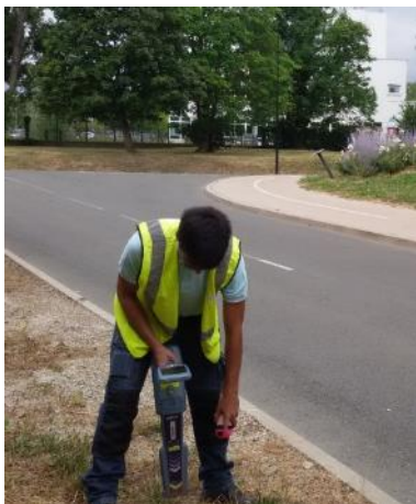
Figure 2 : Détection électromagnétique
