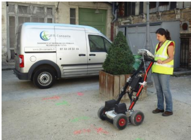
Figure 6 : Détection par géoradar
