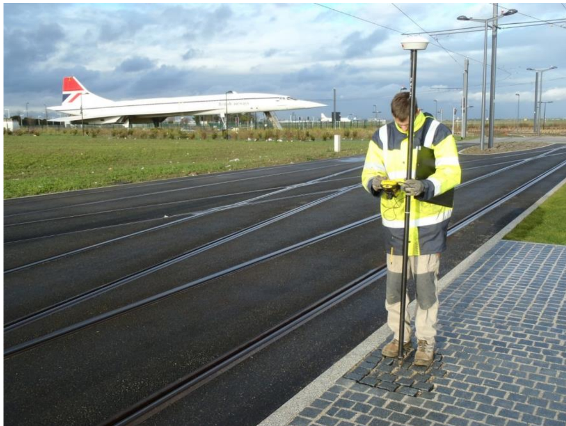
Figure 10 : Géoréférencement par GPS (Trimble)
