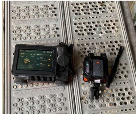
Figure 3 : Illustration du géoradar utilisé (antenne 2,7GHz)
